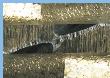
60分钟后刀尖中心的磨损
